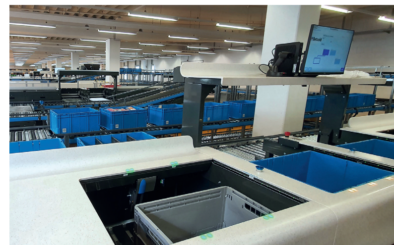
01 Die „Ware zum Mann“-Kommissionierung mit ergonomisch höhenverstellbaren Arbeitsplätzen
