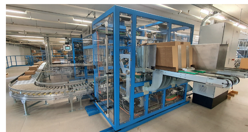
02 Die Volumenreduziermaschinen verringern ungenutzten Raum in den Paketen. Dies spart Versandvolumen und überflüssiges Polstermaterial
